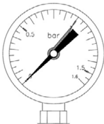
Рисунок носит ознакомительный характер, котел давлением 0,7 бар.
